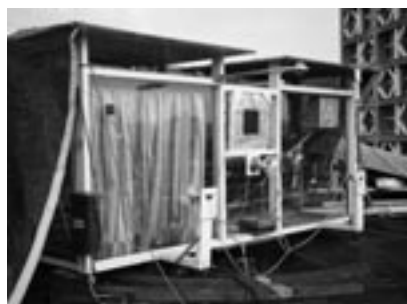
写真1 日除けの日射遮蔽係数測定装置
