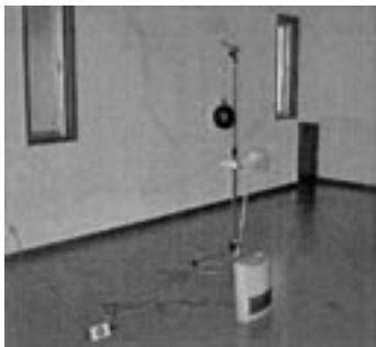
写真 実証住宅での断熱性能測定風景
