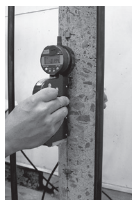
写真3 モルタルおよびコンクリートの長さ変化試験状況 (ダイヤルゲージ方法)
