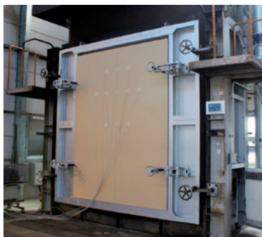
写真2 燃焼試験の状況
