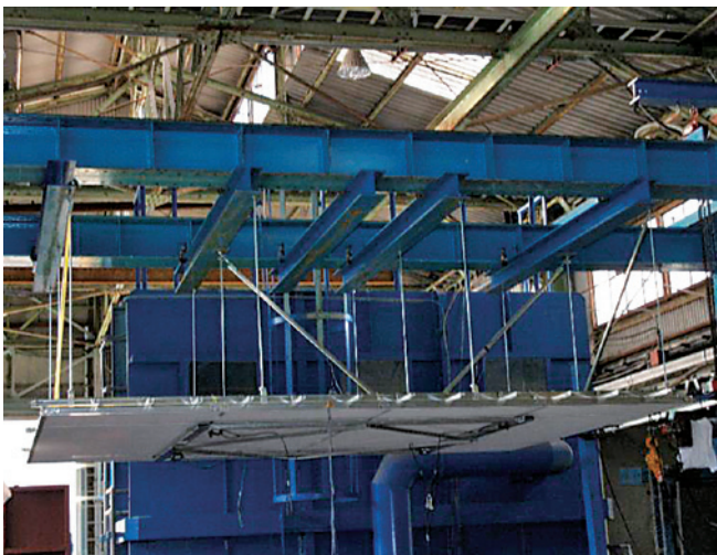
写真3 試験実施状況 (システム天井)
