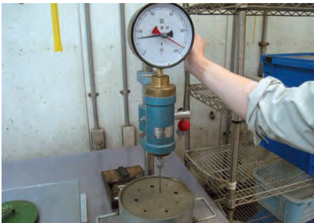
写真4 凝結時間試験状況
