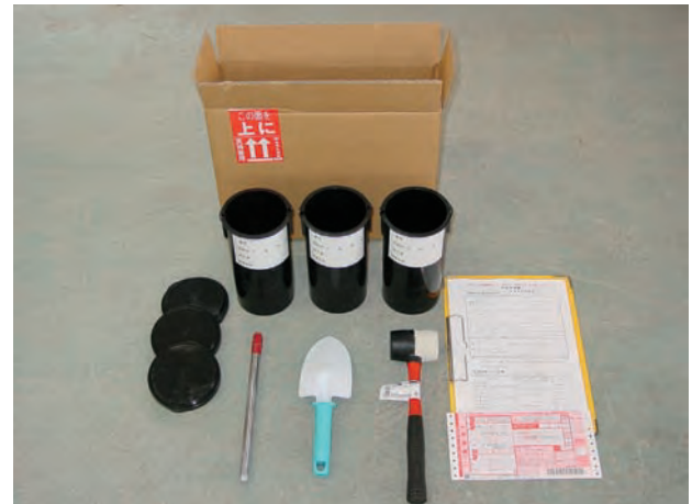
写真6 強度検査セット
