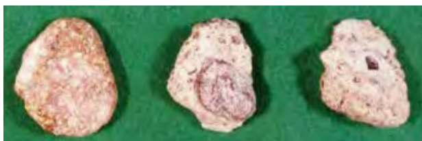
写真3 再生粗骨材の粒子構成の例 (左より、原骨材、原骨材にモルタルが付着、モルタル粒子)
