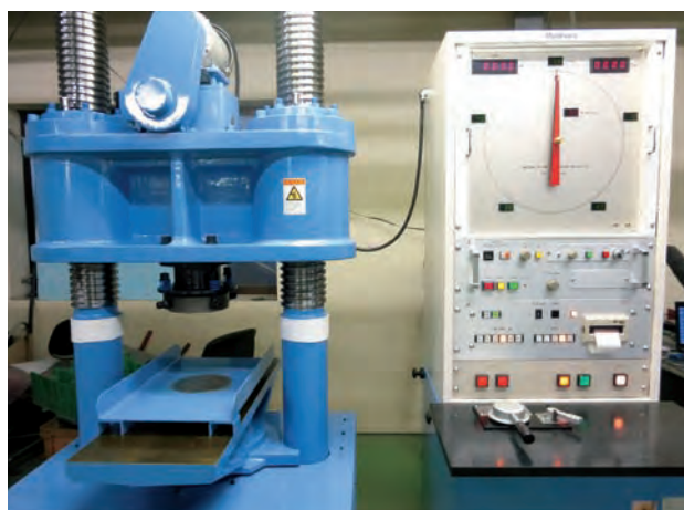
写真1 2000kN圧縮試験機
