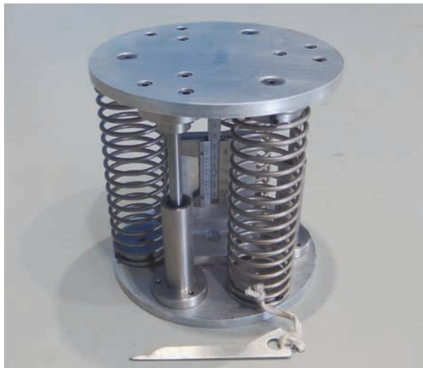
写真2 危害防止措置試験（運動エネルギー）装置
