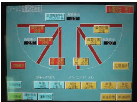
写真2 開閉繰返し試験装置【制御盤】
