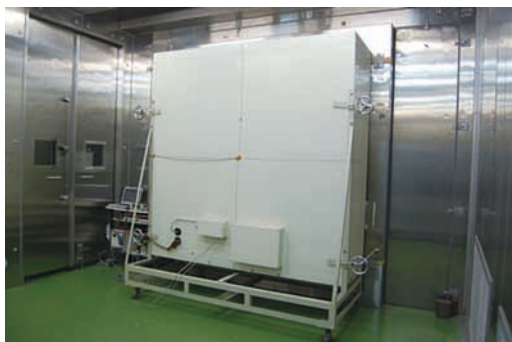
写真4 高温室内部(加熱箱を設置した様子)
