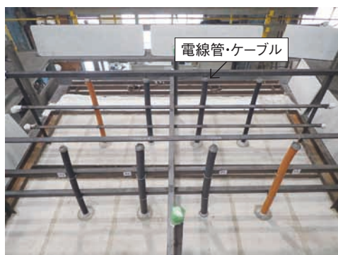
写真3 試験体の設置例(防火区画貫通部)
