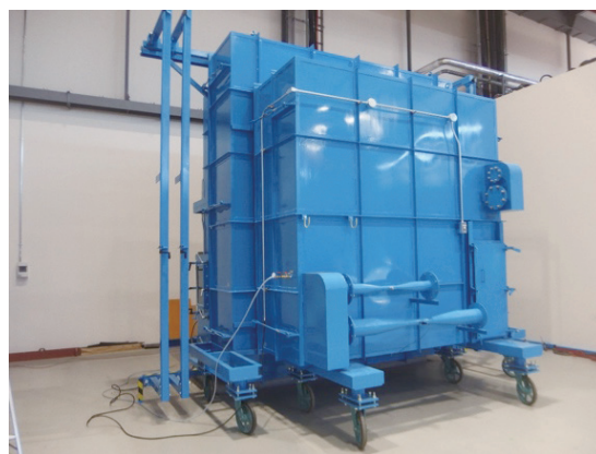
写真2 気密性試験状況 (装置に試験体が設置され、気密箱が設置されている様子)
