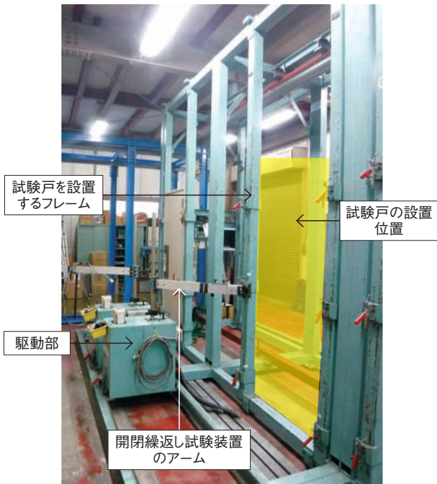
写真1 開閉繰返し試験装置
