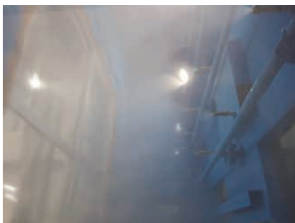
写真3 水密性試験状況 (試験体に水が噴霧されている様子)
