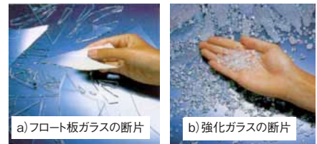
ガラスの処理方法の違いによる破壊状態の違い
