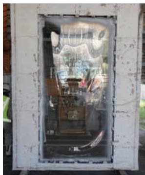
写真2 加熱後の複層ガラス
