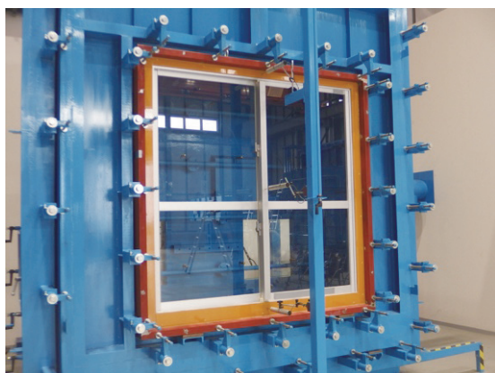
写真1 耐風圧性試験状況 (装置にサッシを設置し、測定器が付いている様子)
