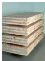
[今号の表紙] ログハウスの部材間の 摩擦係数算出試験に 用いたCLT部材
