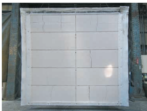
耐力壁の2時間耐火性能試験後の試験体
