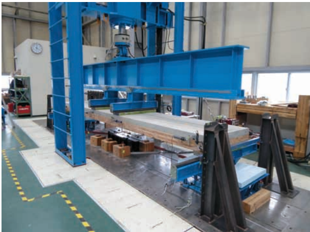
写真5 床の曲げ試験例
