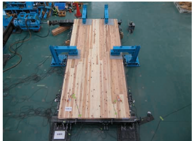
写真2 床の面内せん断試験例（水平設置での実施）
