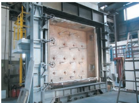
写真1 载荷加熱炉(耐力壁の試験対応)
