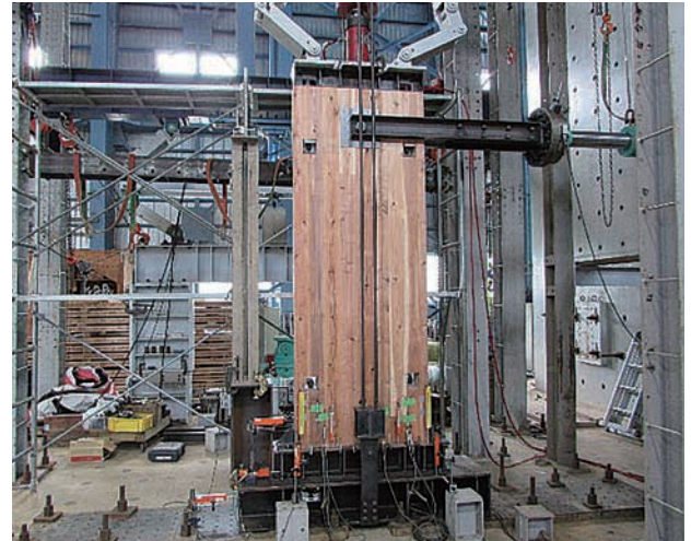
写真1 鉛直荷重をかけた実験
