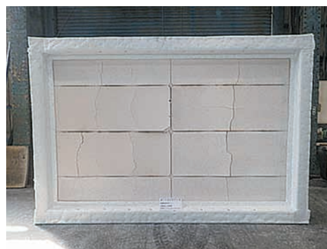
屋根の30分耐火性能試験後の試験体
