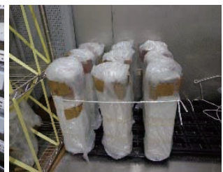
写真10 供試体の 40^\circ\text{C} 恒温室内での貯蔵状況
