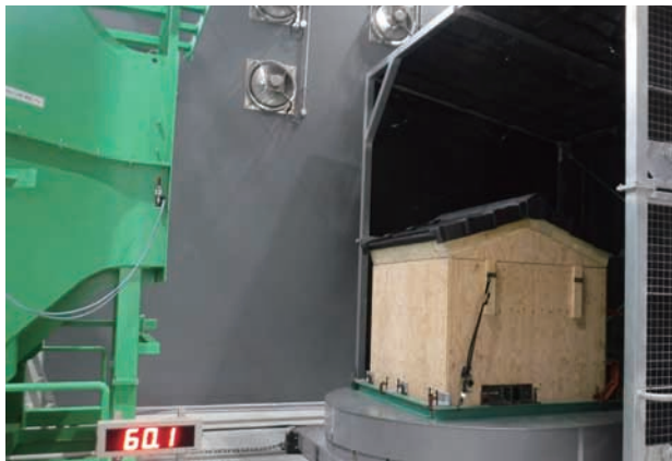
写真3 瓦葺き屋根の送風試験
