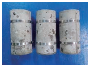
写真12 供試体へのステンレスバンド取付後の状況
