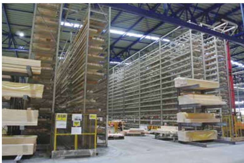
写真6 同上、多棟木拾装置(自動立体倉庫)
