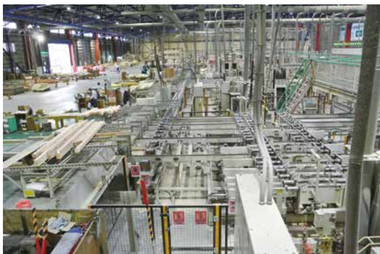
写真5 ポラテック株式会社 坂東工場 木造軸組工法のプレカットの生産ライン
