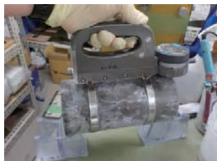
写真13 長さ変化測定状況(コンタクトゲージ方法)
