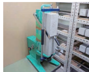
写真9 長さ変化測定状況(ダイヤルゲージ方法)
