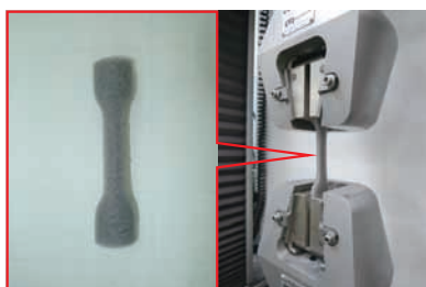
写真2 ダンベル型に打ち抜いた試験片(左)と引張試験の状況(右)
