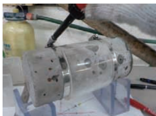
写真11 供試体へのステンレスバンド取付状況
