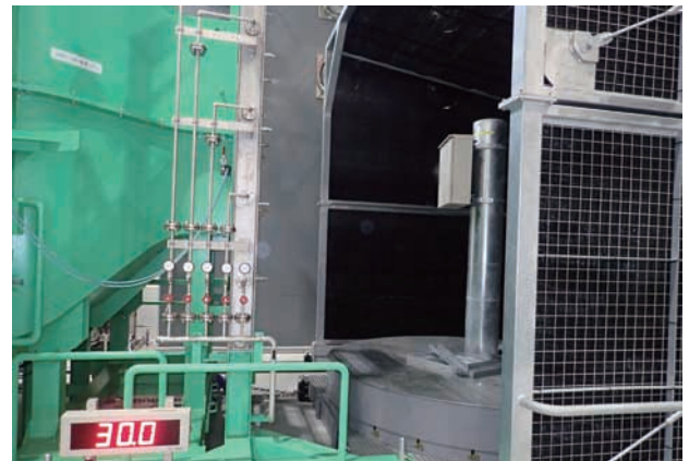
写真4 キャビネットの送風散水試験
