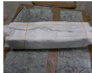
写真7 供試体の被覆状況(ゴム止め)
