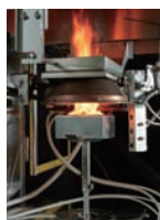
[今号の表紙] コーンカロリメーターによる発熱性試験の様子
