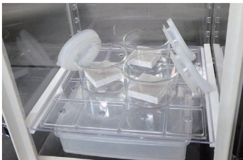
写真2 デシケーター内の試験体
