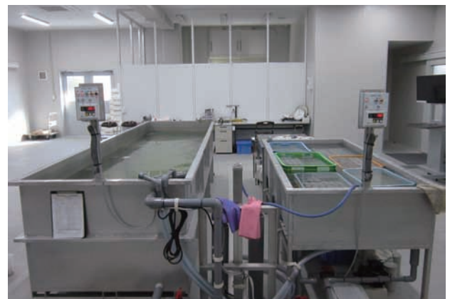
写真6 標準養生水槽
