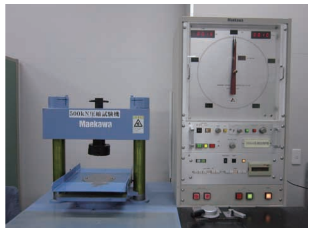
写真5 500kN圧縮試験機
