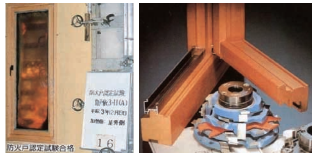
図11-20 防火戸認定の木製サッシ 複層ガラスと木製サッシを使用した乙種防火戸
