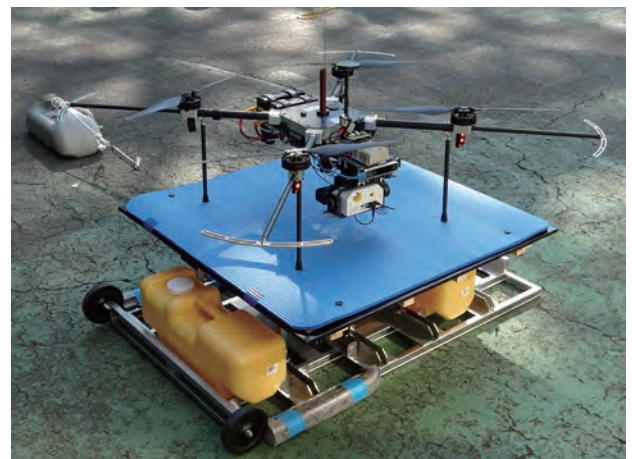
写真2 近接調査用ドローンシステム 7)
