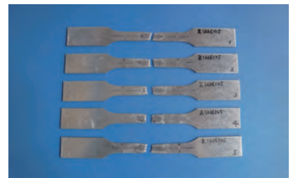
写真3 試験後の試験片
