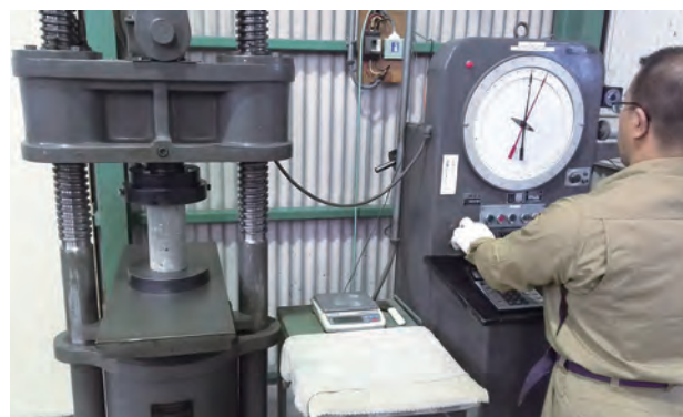
写真1 コンクリートの圧縮強度試験実施状況
