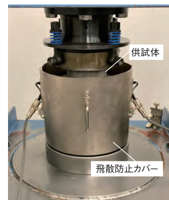
写真2 供試体取り付け後の測定装置
