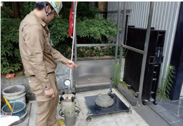
写真2 生コンの性状検査
