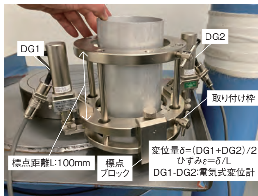
写真1 供試体取り付け前の測定装置
