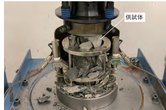
写真4 試験後の供試体の破壊状況
