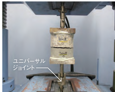
写真4 付着強度試験状況の一例
