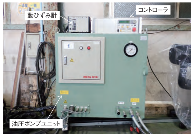
写真1 自動載荷装置
