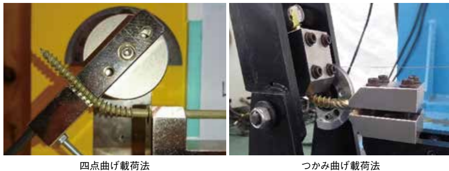
写真1 単調曲げ試験における試験状況
