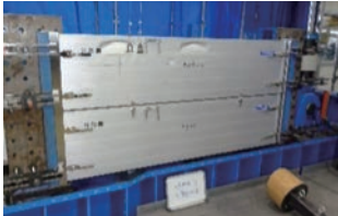
写真5 損傷状況 ・加撃点のパネルの変形
