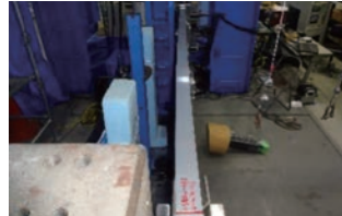
写真6 損傷状況 ・パネルの残留たわみ
