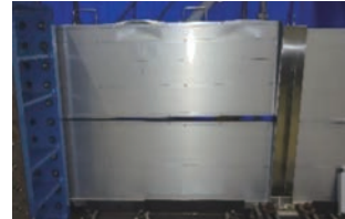
写真7 損傷状況 ・加撃点のパネルの変形 ・パネル相互のずれ
