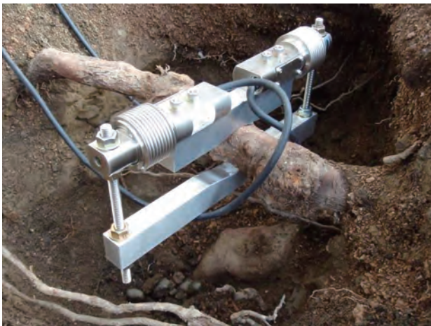
写真8 根に取り付けた肥大力測定装置
