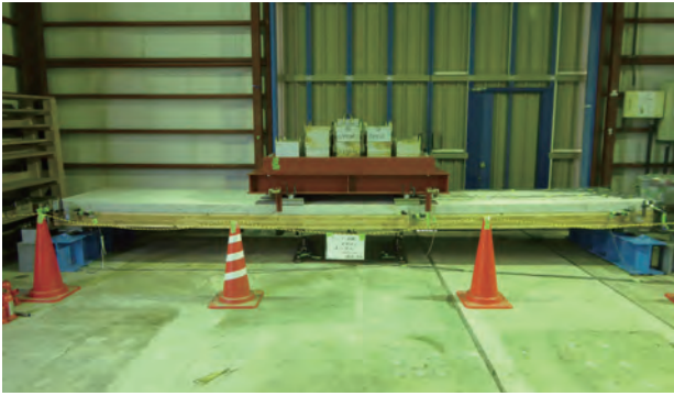
写真1 クリープ試験の様子
