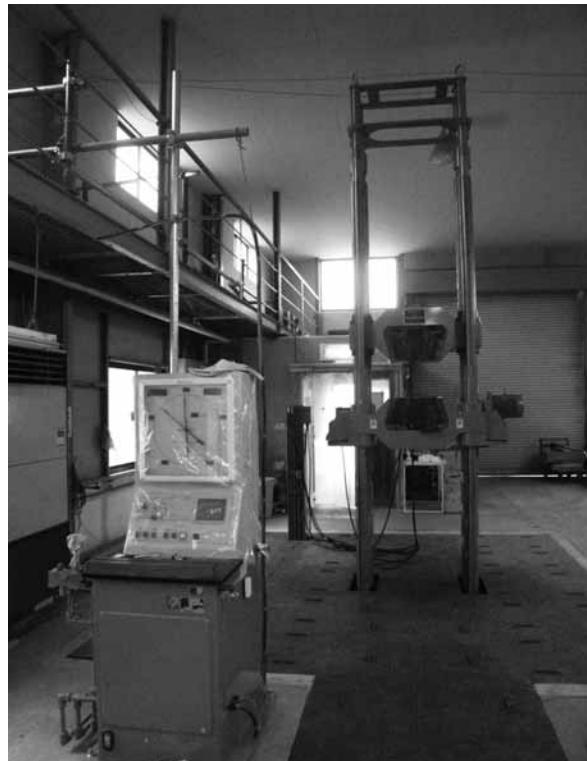
写真1 2000kN万能試験機
