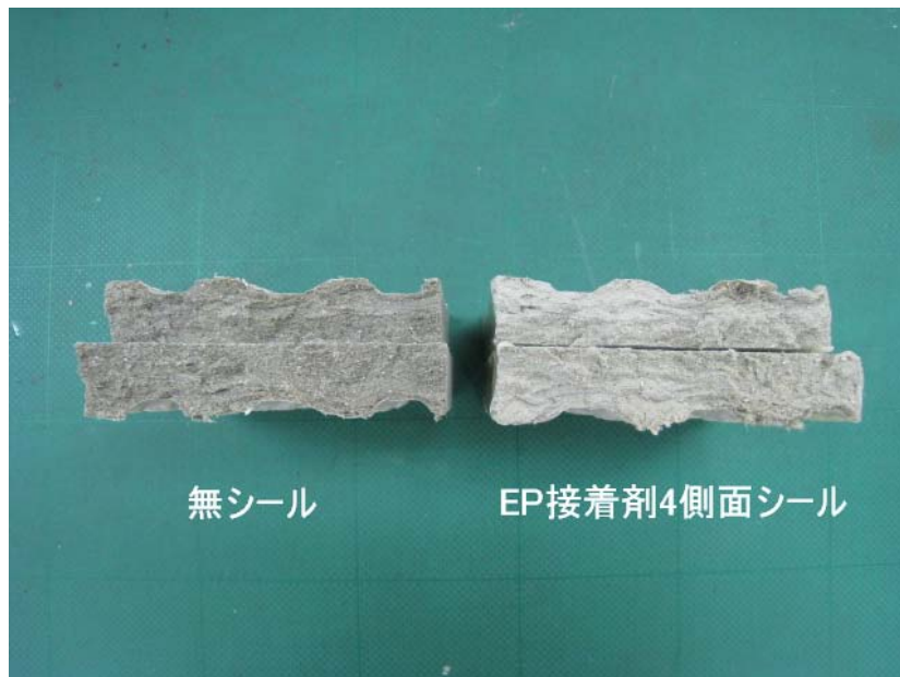
写真 2.1 40 サイクル後の繊維補強セメント板系断面
