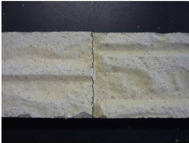
写真 4.2 種類 C-3 無処理 No.1 試験体の曲げ試験後の状況
