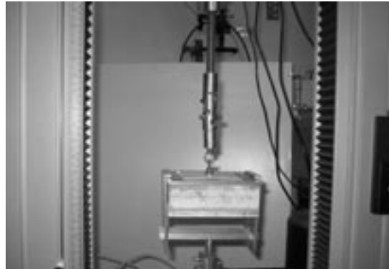
写真7 付着強度試験状況
