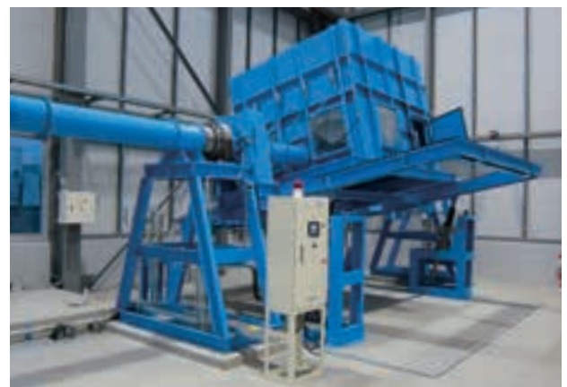
写真6 屋根チャンバー(試験体2050mm×2100mm時)
