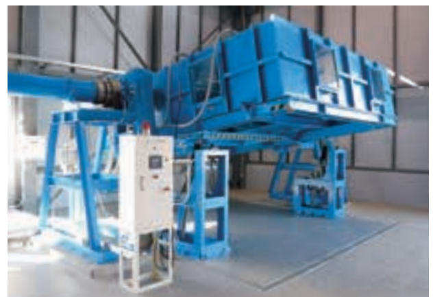
写真5 屋根チャンバー(試験体4180mm×3680mm時)
