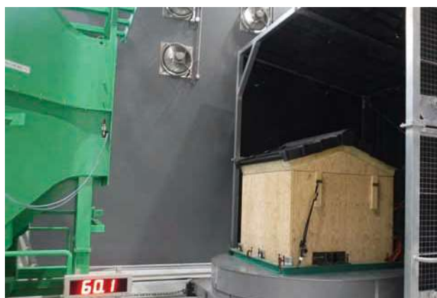
写真3 瓦葺き屋根の送風試験
