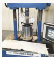
CBR貫入試験装置
