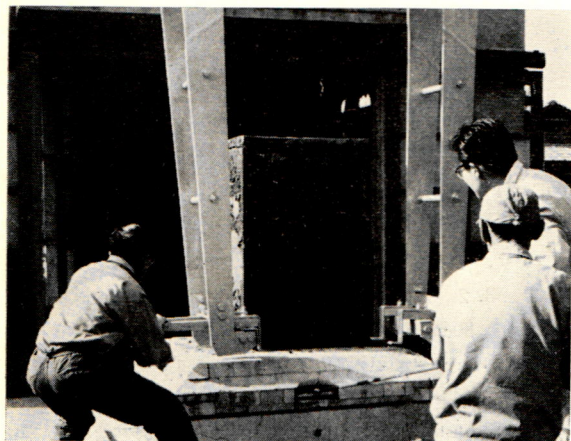
加熱金庫を引出し、懸垂装置にかける
