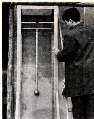
写真4 塗り外壁の衝撃試験
