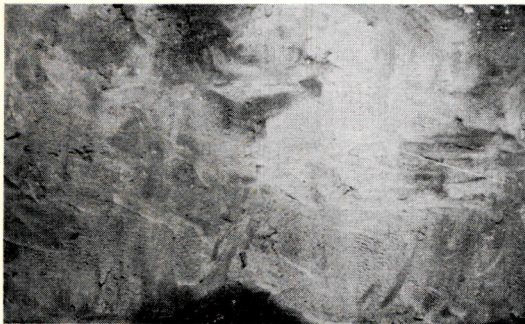
⑤ブリキ板，前処理，モルタル塗り施工後24時間
