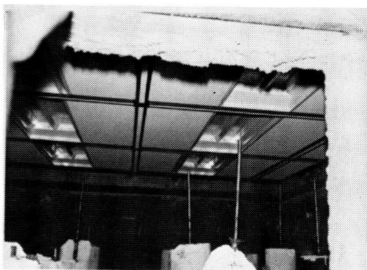
写真3 水平炉内部（上部は天井の試験体）
