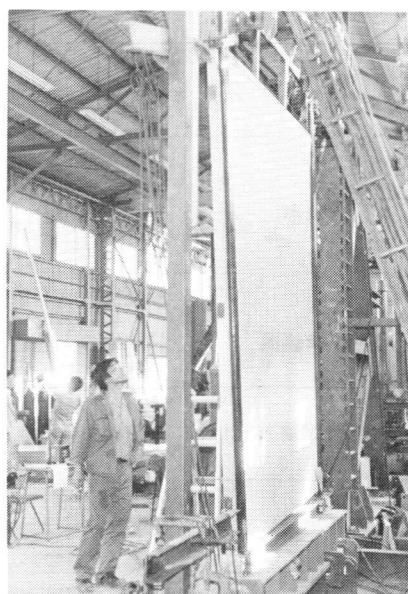
写真-5 木質系住宅構成材(壁パネル)のせん断耐力試験
