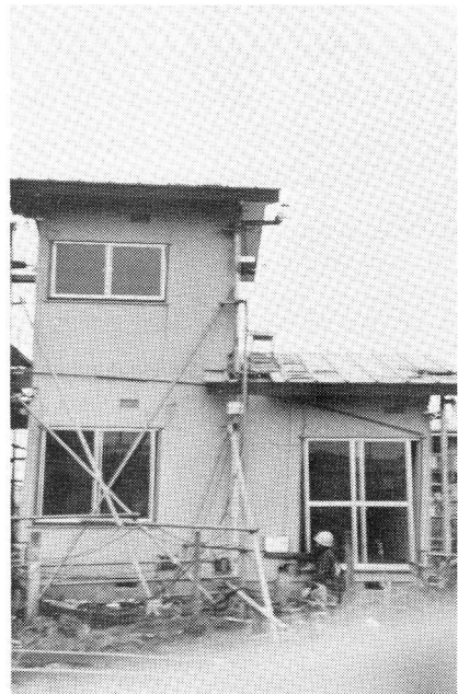
写真-1 実大プレハブ住宅の動荷重試験
