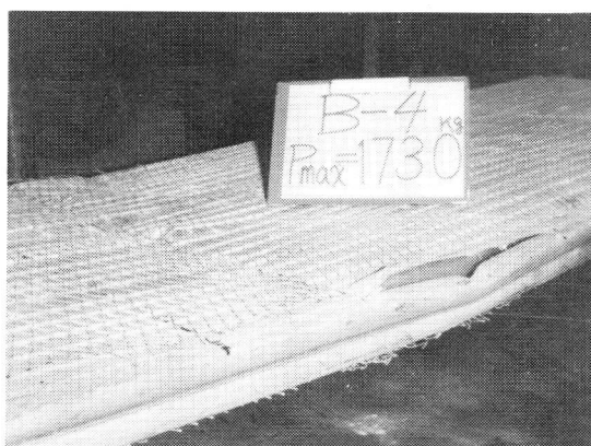
写真-5 破壊状況
