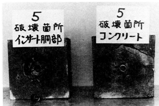
写真-3 破壊状況
