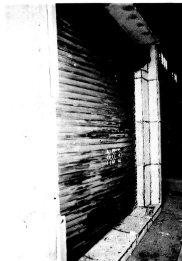
写真-3 No.3試験体 2時間加熱後における加熱面の状況
