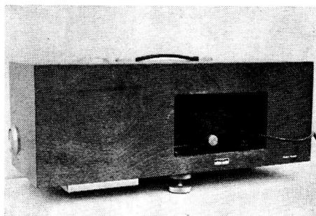
図-3 BK 3204型タッピングマシン (新型は支持脚が横に広がるようになっている)
