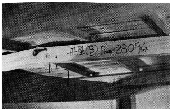
写真-4 破壊状態(試験体2)
