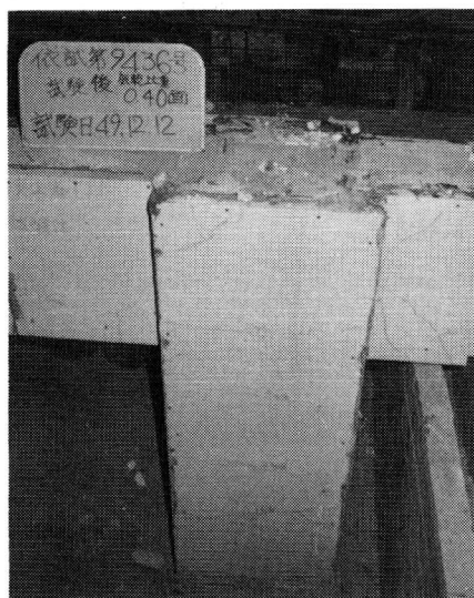
写真-4 試験後の柱部 (石綿けい酸カルシウム板の気乾比重0.40の面)
