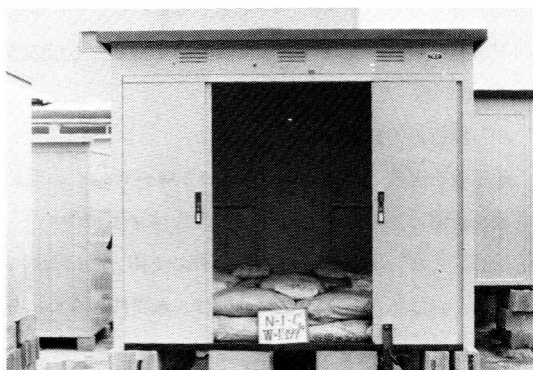
写真-4 床の等分布載荷試験の実施状況
