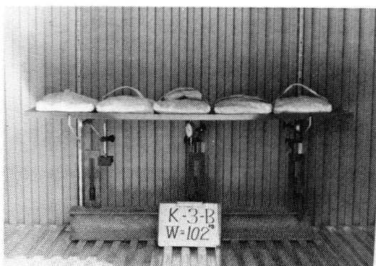
写真-3 棚板の等分布載荷試験の実施状況
