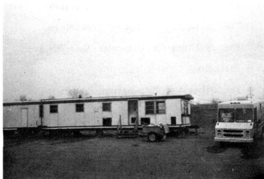
写真-40 NBS モービルハウスの内装火災実験場。左がモービルハウス、右端は試験装置を装備した自動車。
