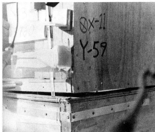
写真-6 破壊状況 2階下枠と床のひらき 試験体記号 A-1
