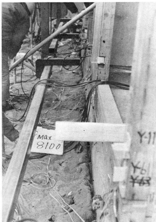
写真-8 破壊状況 D通り基礎の浮上り 試験体記号 A-1
