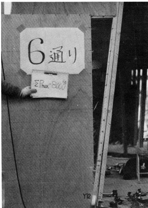
写真-12 破壊状況 6 通り耐力壁(No.3)の破壊 試験体記号
