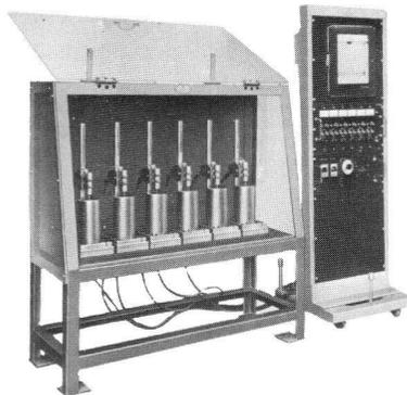
繰返し衝撃破壊試験機
