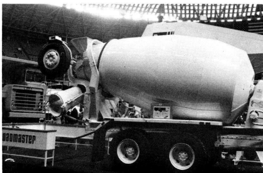
写真-6 代表的なコンクリートミキサー車
