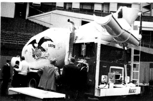
写真-8 投入口を運転台の前につけて、操作をしやすい しているコンクリートミキサー車
