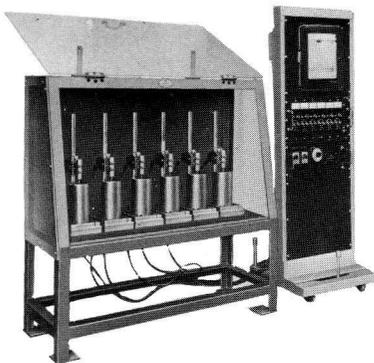
繰返し衝撃破壊試験機
