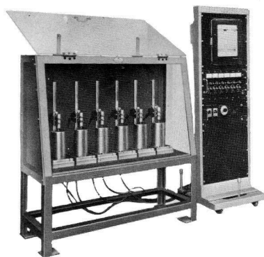
恒温槽付シーリング材疲労試験機
