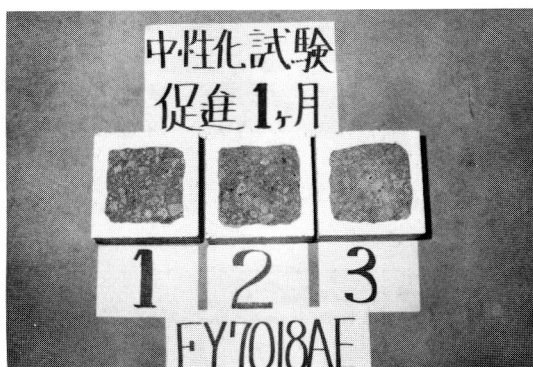
写真-1 1 ヶ月後の中性化深さ
