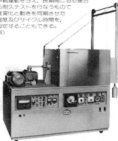
恒温槽付シーリング材疲労試験機
