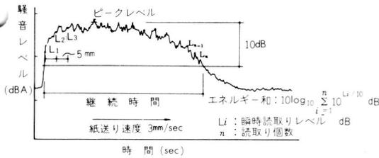
図-6 給水時ボールタップ発生音の騒音レベル変動波形
