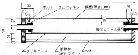
図-2 試料加熱装置断面図
