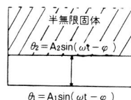
図-1 半無限固体内の温度波モデル
