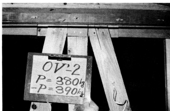
写真-4 破壊状況 (試験体記号 0V')
