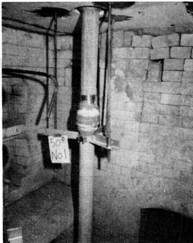
写真-3 試験体の設置状態(炉内側の全体)
