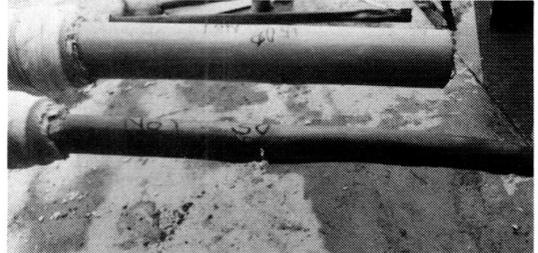
写真-10 試験体の塩化ビニル管の熔融変形の状態（炉外側）
