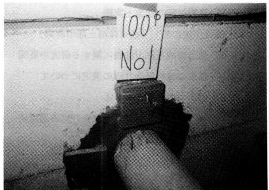
写真-41 試験体の加熱終了後の貫通孔部の状態
