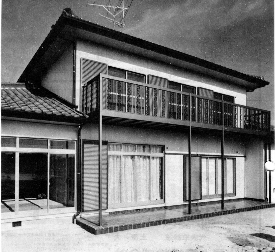
アルアル/バルコニーはオールアルミ製、錆に強くいつまでも美しさを保ちます。しかも完全排水雨樋、内側をスッキリ見せるカバープレートなど数々のユニークなアイデアがすみずみに生かされ他のバルコニーを近づけません。色はシルバーとブロンズの2色、重厚な趣みきを与えます。そして柱建て式と屋根置き式、どちらのタイプも施工は簡単、強度も十分です。パネルの種類は全部で14種、スチールタイプ、アルミ鋳造タイプ、アルミ格子タイプと予算、個性に応じてお選びいただけるワイドバリエーション。自由に組み合わせて「自分だけのバルコニー」をお作りください。
