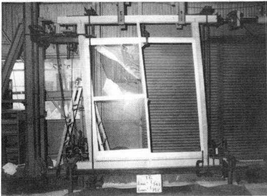
写真-1 テラス型の破壊状況（ガラスの割れ）
