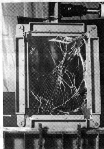
写真-2 フィルムを貼付した板ガラスの破壊状況
