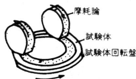
図-7 摩耗試験(テーバー形)
