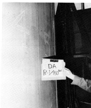
写真-3 試験体記号; DA ( R = 1/150\text{rad} 加振後のパネルのはらみ出し) の試験実施状況
