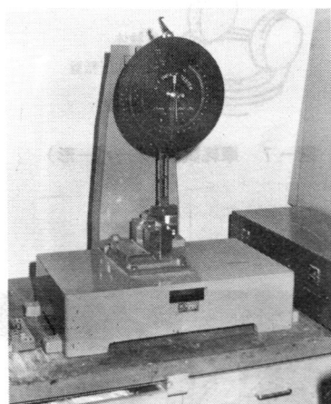
写真-2 シャルピー・アイゾット兼用型衝撃試験機
