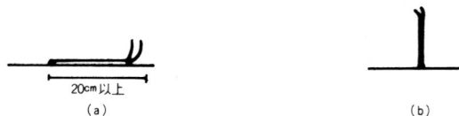
図-7 熱電対の貼り付け方法
