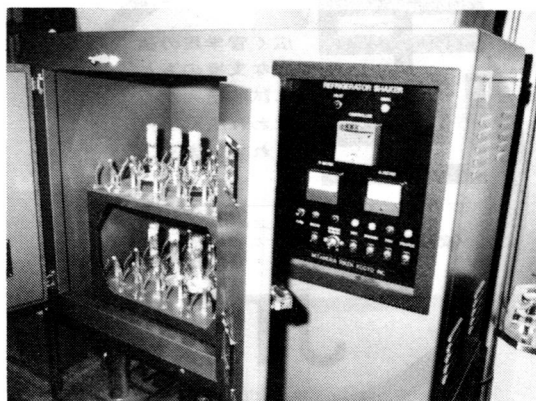
写真-3 振とう培養器
