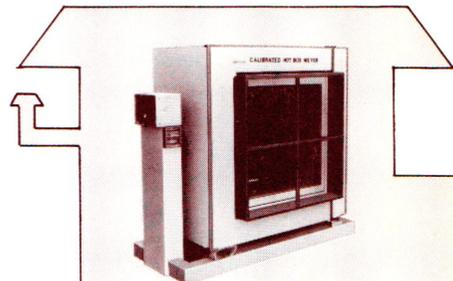
住宅用断熱材/断熱性能試験装置 CHB-20型
