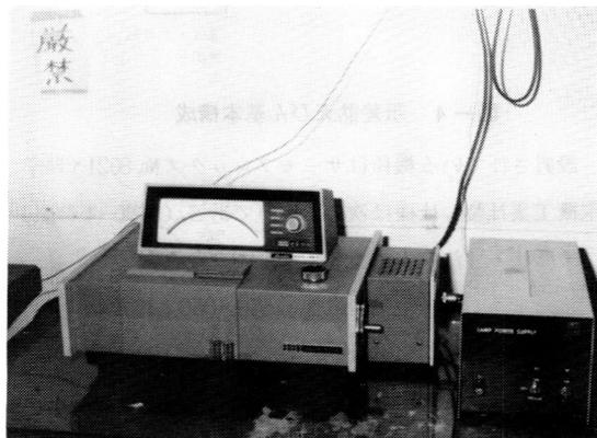
写真-3 光電分光光度計
