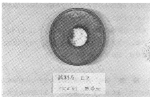
写真-2 防かび性試験結果
