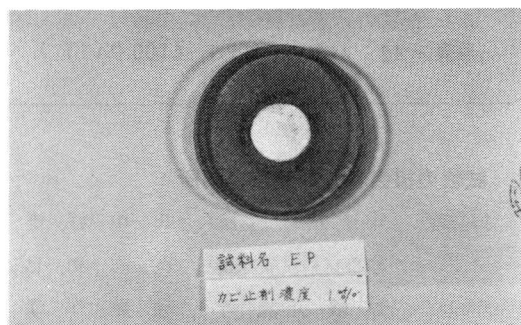
写真-1 防かび性試験結果
