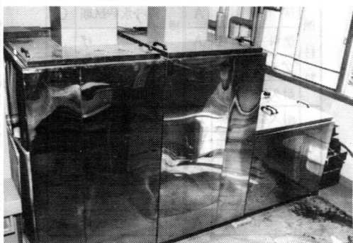
写真一 試験槽と予備槽
